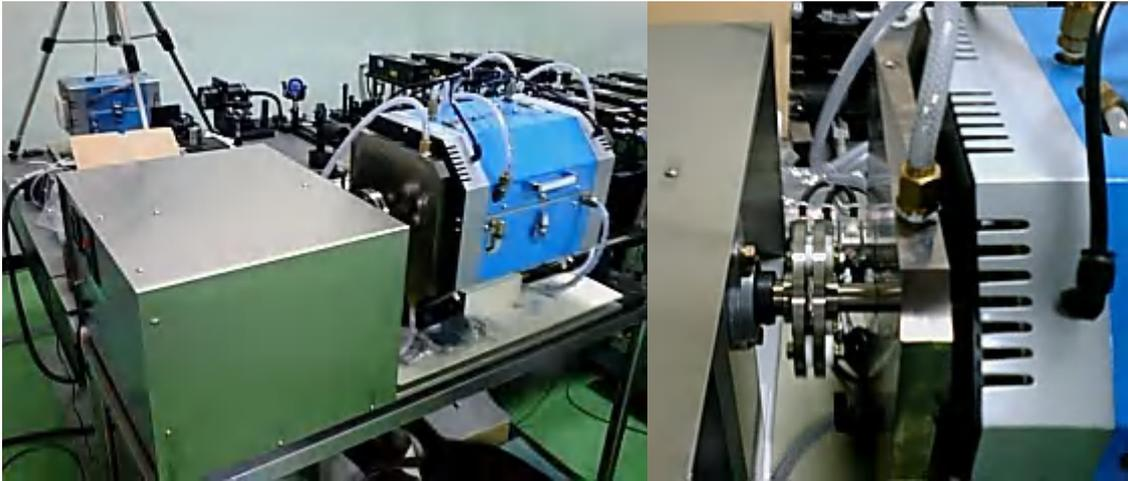
電気炉内試験片回転装置 レーザー照射温度測定実験 60~1200rpm
