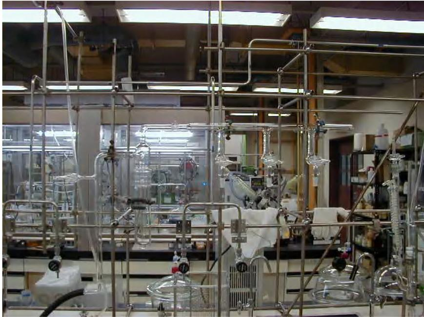
真空ライン 全長：1000mm ガス置換装置；3本 真空トラップ；1000ml
