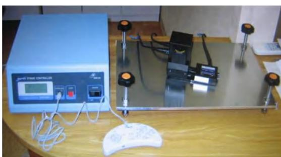
XYZ 軸自動ステージ用傾き補正付台
