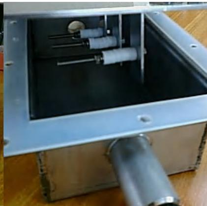
スーパーステンレス NSSC270 腐食試験容器
