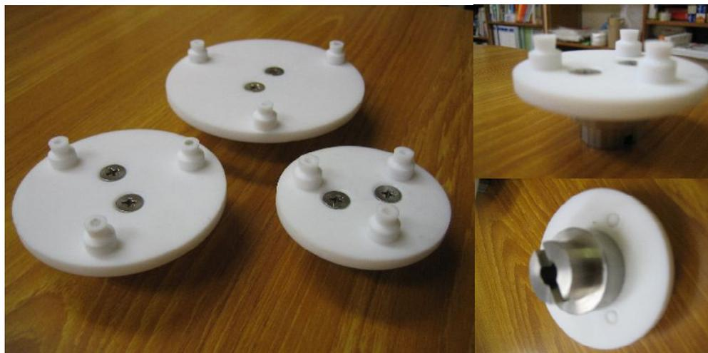
テフロン ウェハ回転乾燥治具 (スピナーヘッド SUS304 製)
