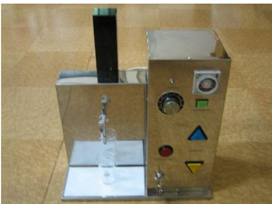
試験片上下装置(コーティング装置)
